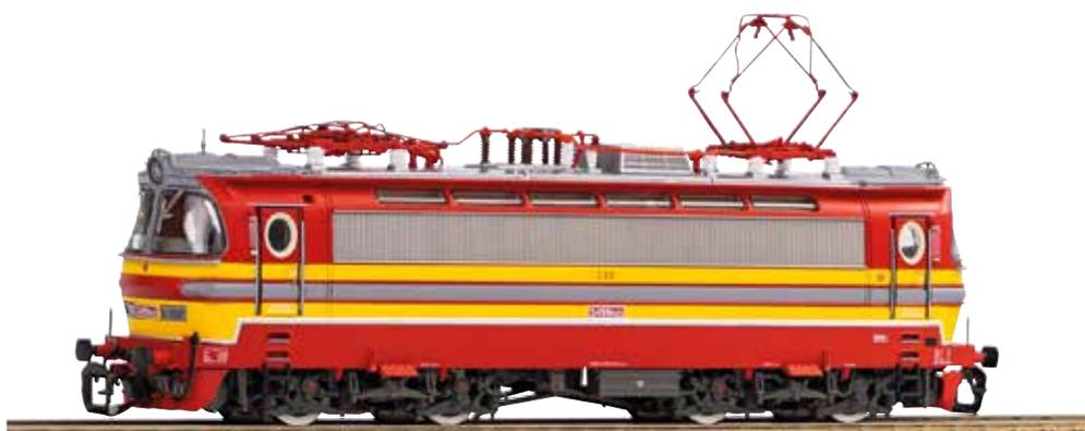
Die Maschinen vom Typ Škoda 47E zählen zu den auffälligsten Elektroloks auf europäischen Gleisen. Besonderes Merkmal ist hierbei der aus glasfaserverstärktem Kunststoff gefertigte Lokkasten, welcher den Loks den Spitznamen „Laminátka“ einbrachte. > **siehe Seite 14**
